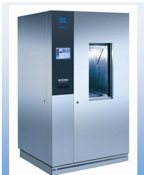
L'autoclave puo' essere alimentata con vapore di rete oppure tramite generatore di vapore integrato, pompa per il vuoto ad anello liquido accoppiata a scambiatore di calore per l'abbattimento termico degli scarichi (max 55°C)
