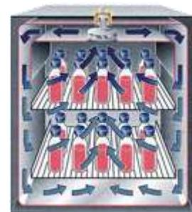
Questo metodo permette di riscaldare e raffreddare gli articoli trattati con una distribuzione della temperatura ed una pressione controllata all'interno della camera compensando la pressione interna generata in recipienti chiusi contenenti liquidi. Grazie al rapido riscaldamento e raffreddamento, questo metodo risulta idoneo per terreni di coltura sensibili.
