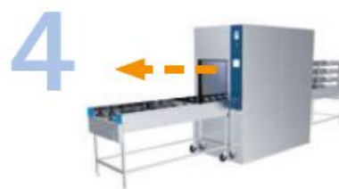
Ritorno automatico dei 2 carrelli nel lato carico
